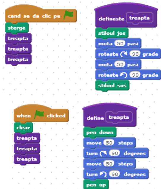
Fig. 4.158 Realizarea efectului de "coborâre scară". Blocul personalizat realizează desenarea unei singure trepte. Blocul va fi folosit în mod repetat
