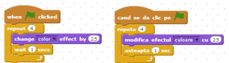
Fig. 5.10 Script ce modifică de patru ori culoarea personajului, la interval de 1 secundă
